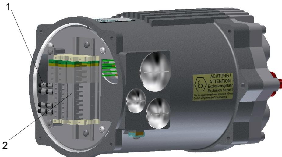
**Bild 4:** 1... Schirmanschlussklemme, 2... Klemmleiste
